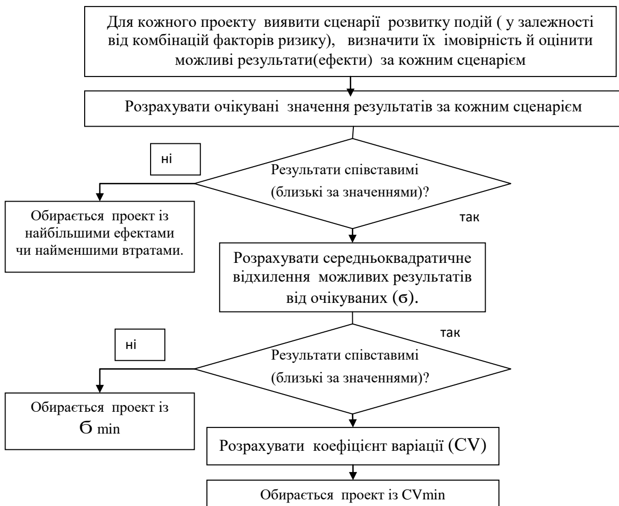
Рис. 2.3.7. Спрощена блок-схема алгоритму кількісного аналізу ризику інноваційного проекту (сценарно-імовірнісний підхід).
